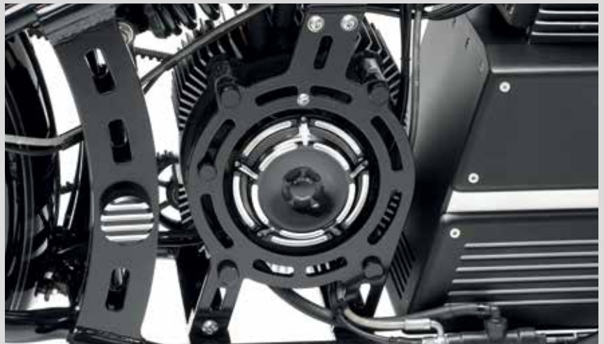
Die Federbeine von Progressive Suspension waren zu schön, um sie zu verstecken. Hinterm Akkublock liegt der Motor, der im Rekuperationsmodus auch Strom generieren kann
