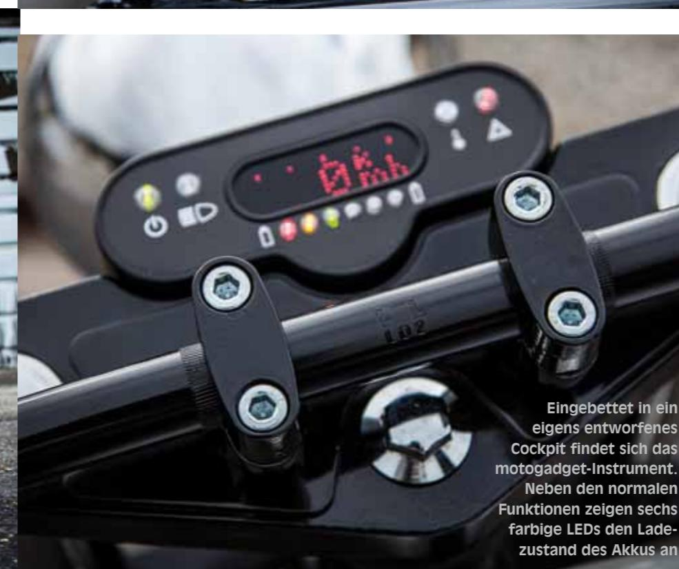
Eingebettet in ein eigens entworfenes Cockpit findet sich das motogadget-Instrument. Neben den normalen Funktionen zeigen sechs farbige LEDs den Ladezustand des Akkus an
